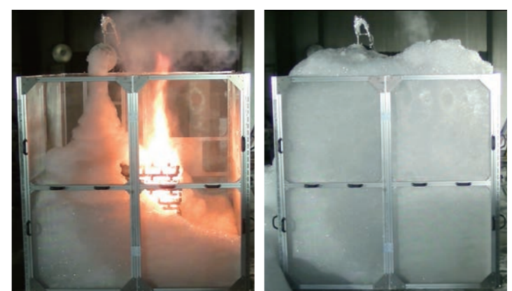
使用不含PFAS泡沫灭火剂“AwaAwa10”的灭火实验
